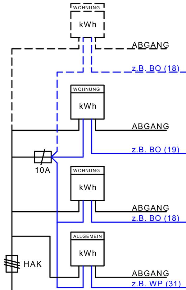
Messung und Steuerung Netzkommando MFH
